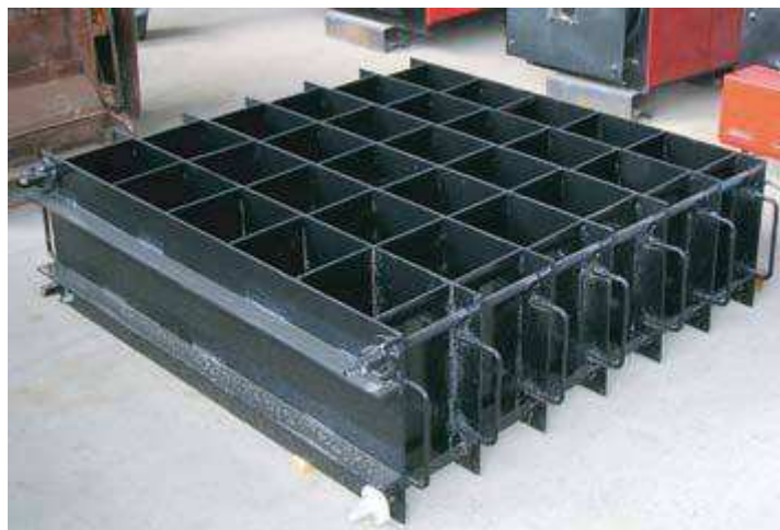
圖二、尺寸 20*20*40 公分之預製水泥塊模型
